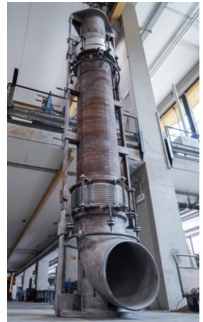
8 Meter lang und 3,2 Tonnen schwer – ein Lateralkompensator in Revision
