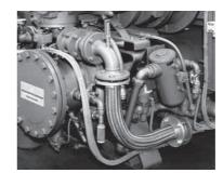
Bild 13.11 Metallschlauch im 90°-Bogen an einem Schraubenverdichter
