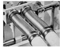
Bild 2.6 Wechselbiegemaschine zur Ermittlung des Ermüdungsverhaltens von dünnen Bändern und Blechen.
