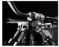
Bild 2.5 Schwingungsprüfungs-Stand zur Simulation komplexer Anwendungsbedingungen.
