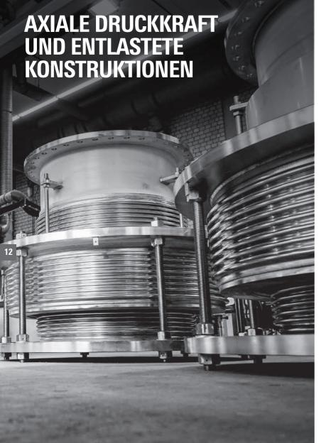
In einer druckführenden Rohrleitung herrscht normalerweise eine Längskraft der Größe  $F_L = a \cdot p$ , wobei a der Rohrquerschnitt und p die Druckdifferenz (innen / außen) ist. Die Druckkraft entsteht durch die axialen Druckkomponenten, die am Ende einer Rohrstrecke auf eine projizierte Abschlussfläche wirken (Bild 12.1).
