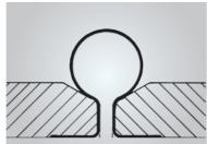
Bild 8.14 Kompensator mit Torusbalg
