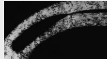
Spaltkorrosion an einem Kaltband aus austenitischem Stahl. Schnittbild (50fache Vergrößerung).
